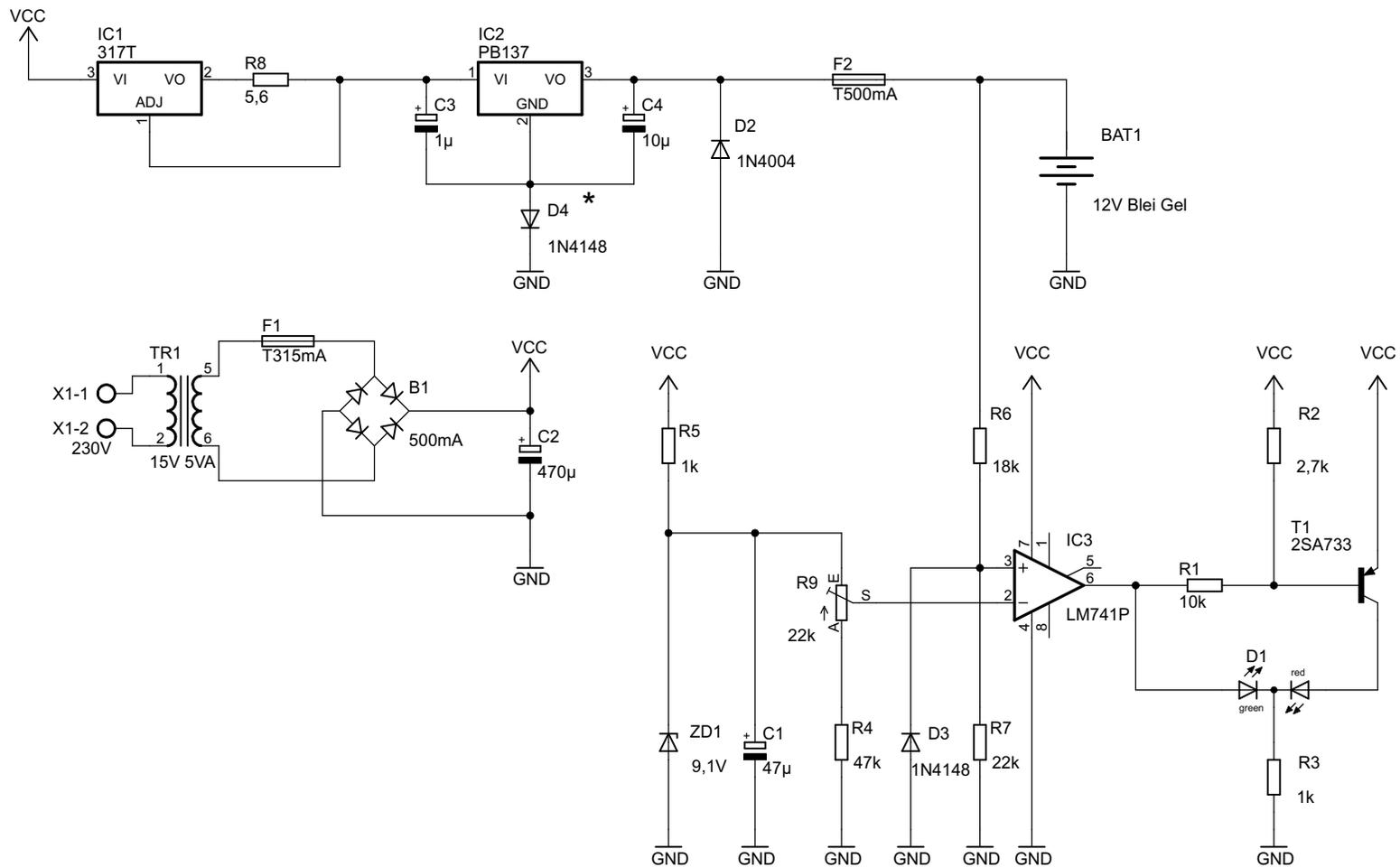
\* Mit Diode ergibt sich eine höhere Ausgangsspannung (etwa 14,5V).
